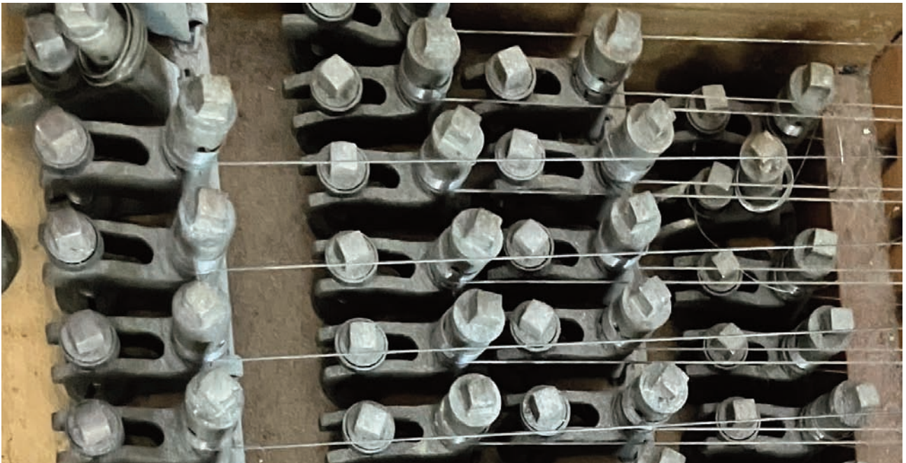
détail des chevilles micrométriques Pleyel-Alibert
